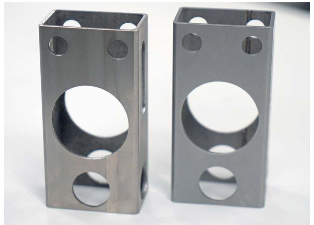
Lasergeschnittenes Kastenprofil vor und nach dem Entgraten.
