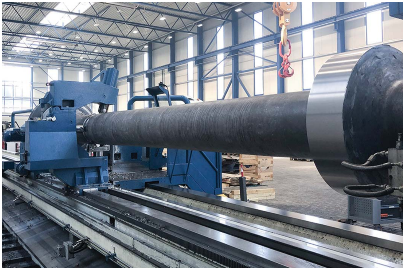
Mit der Schwerdrehmaschine können Wellen mit einer Länge von bis zu 26 Metern und einem Durchmesser von 1.540 Millimetern bearbeitet werden.
