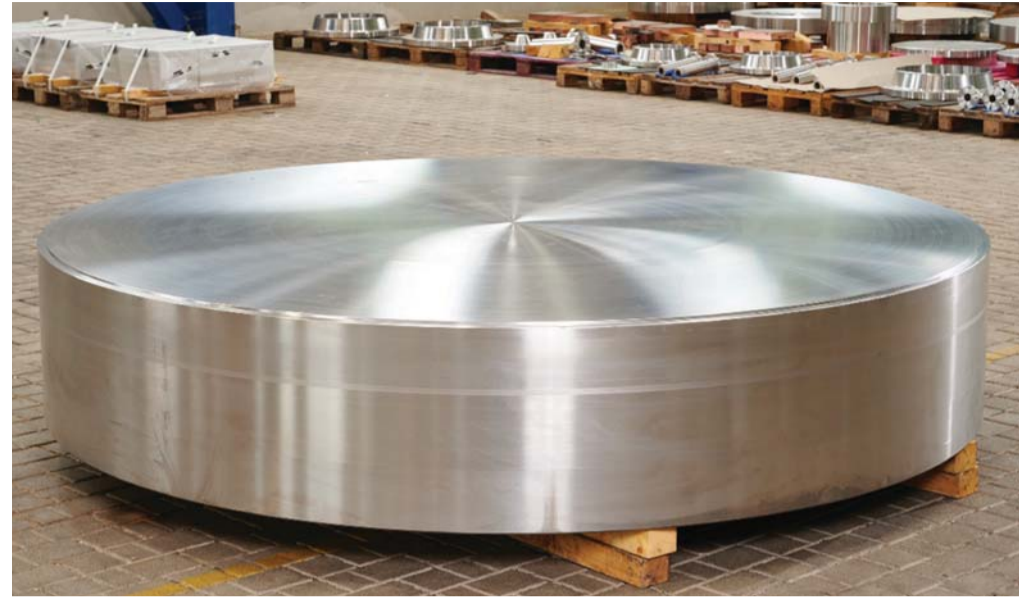
Aus Titan entstehen zum Beispiel geschmiedete Wärmetauscher-Rohrplatten mit einem Gewicht von 15.500 Kilogramm.
