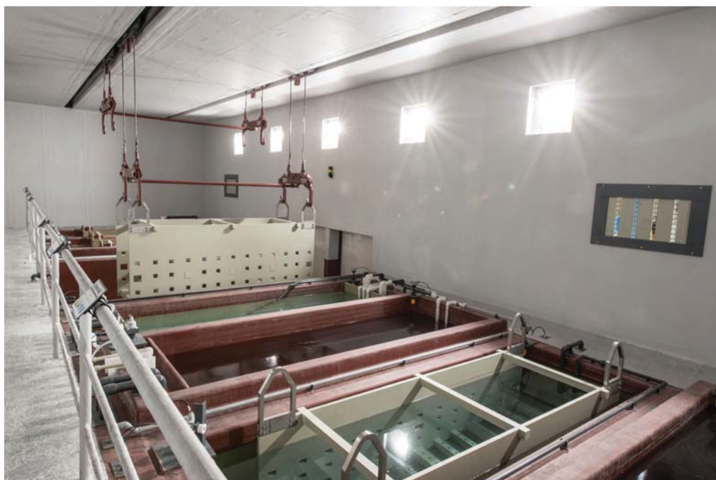
Spezielle Bauteile erfordern spezielle Lastaufnahmemittel, hier säurefeste Beizkörbe für Flugzeugbauteile bei voest.
