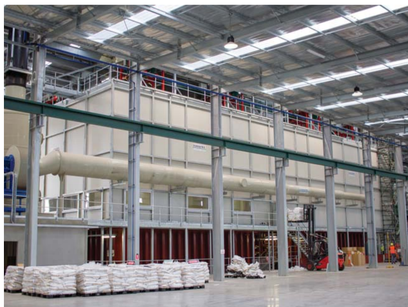
Die gekapselte Beizanlage mit Abluftanlage ermöglicht einen sicheren Betrieb in der gesamten Produktionshalle.
