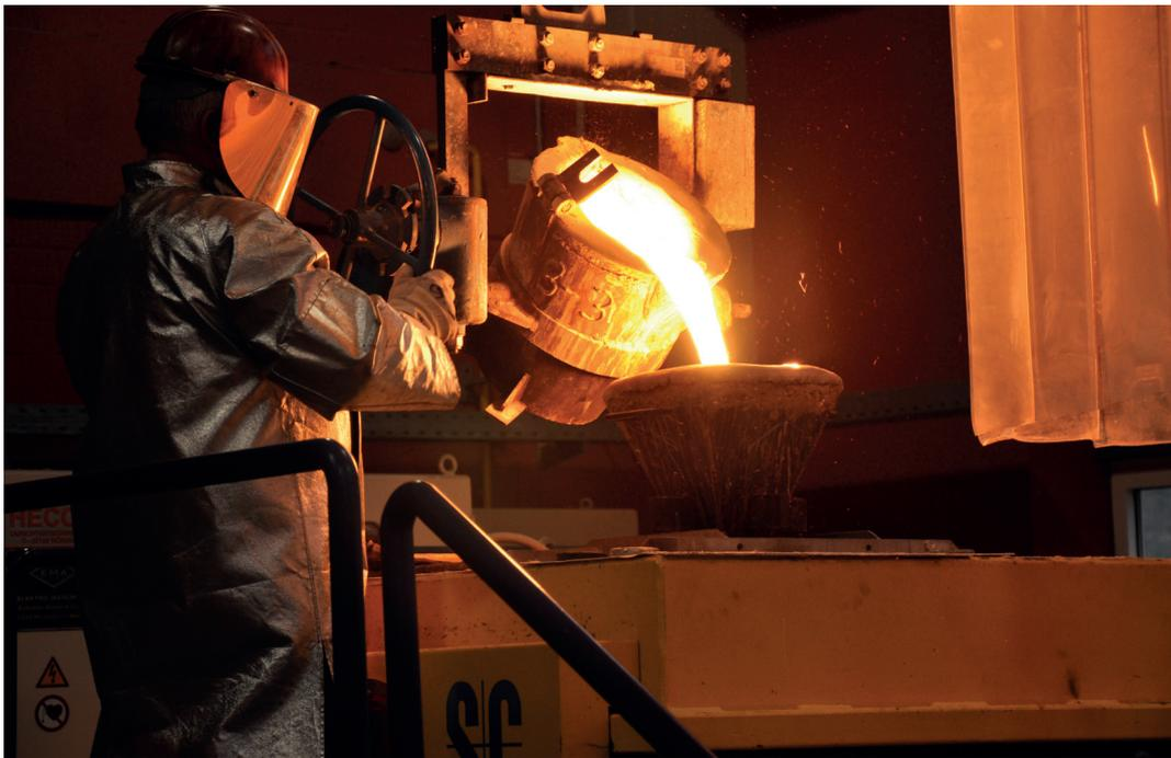
Die Schleudermaschine produziert Versuchsabgüsse in der F+E-eigenen Fertigung. ©Schmidt + Clemens
