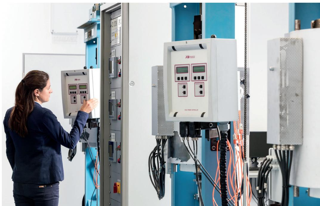
Die F+E verfügt über mehrere Zeitstandöfen mit Online-Überwachung. ©Schmidt + Clemens
