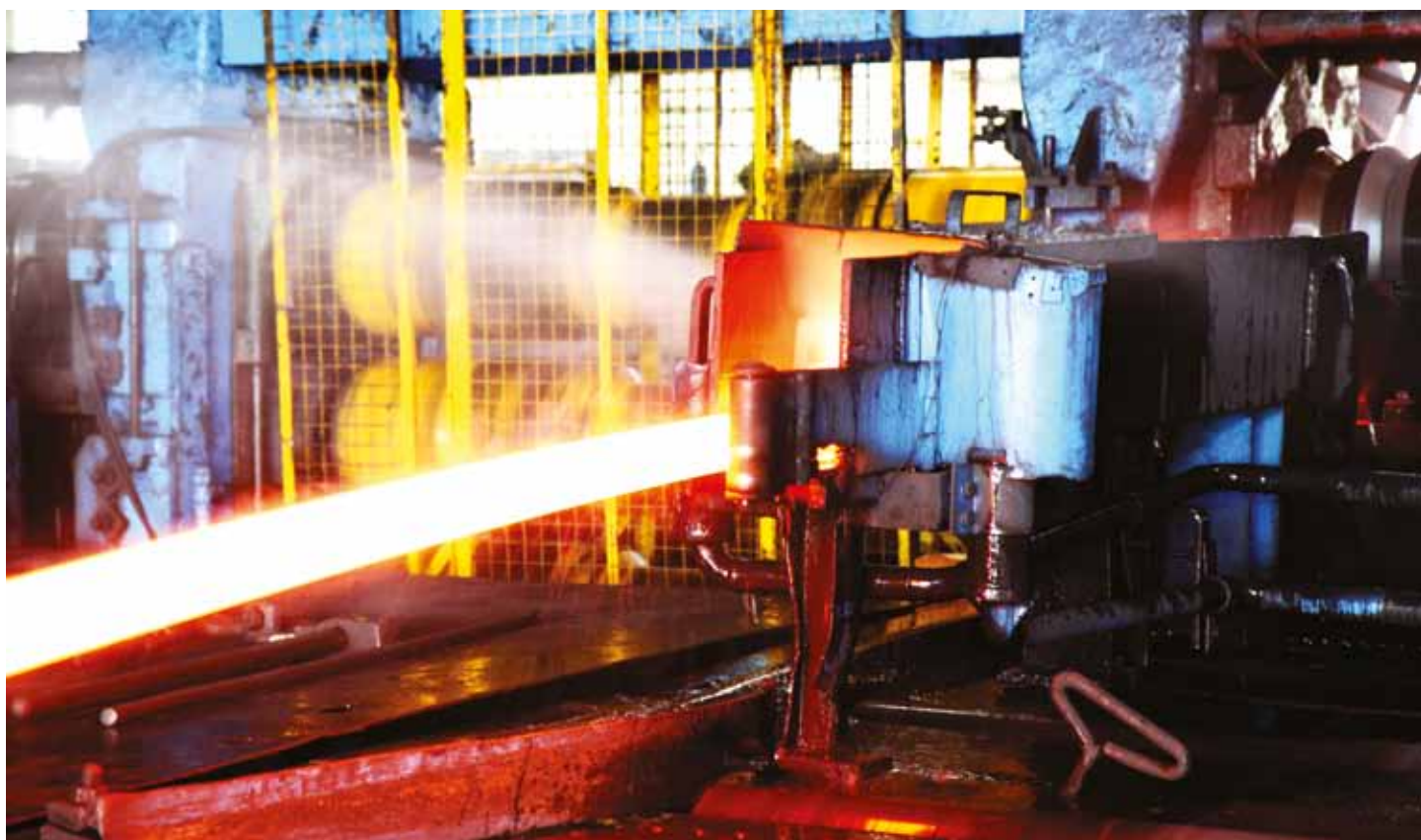
Einblick in den Produktionsprozess: Ein Profil wird gewalzt.
