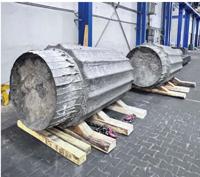
Jedes nahtlos geschmiedete Teil von ROLF KIND wird aus einem gegossenen Rohblock gefertigt. Die verarbeiteten Rohblöcke aus hochlegiertem Edelstahl haben ein Gewicht von 3.000 kg bis 50.000 kg.
