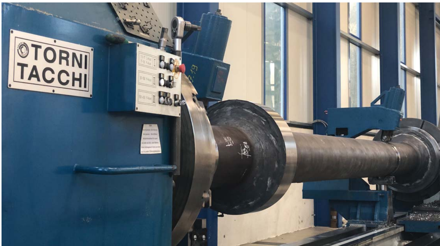
Wahrscheinlich eine der längsten Drehbänke in Europa: Die Drehmaschine Torni Tacchi (HD3-120H CNC) kann Werkstücke mit einer Länge von bis zu 26 Metern und einem Durchmesser von 1.540 mm bearbeiten. Fotos: ROLF KIND GmbH
