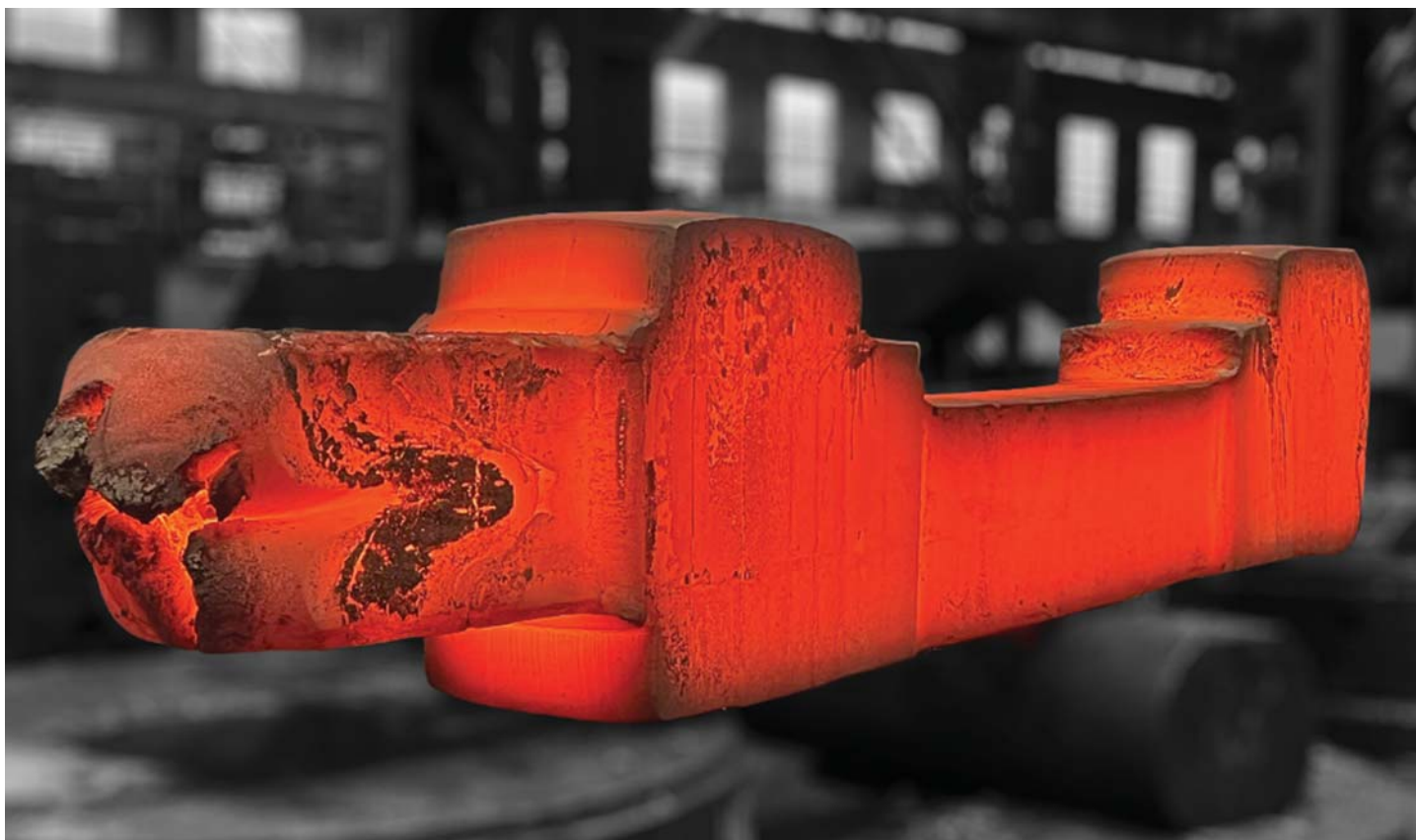
Die plastische Verformung des Rohblocks erfolgt in mehreren Schritten des Schmiedens.
