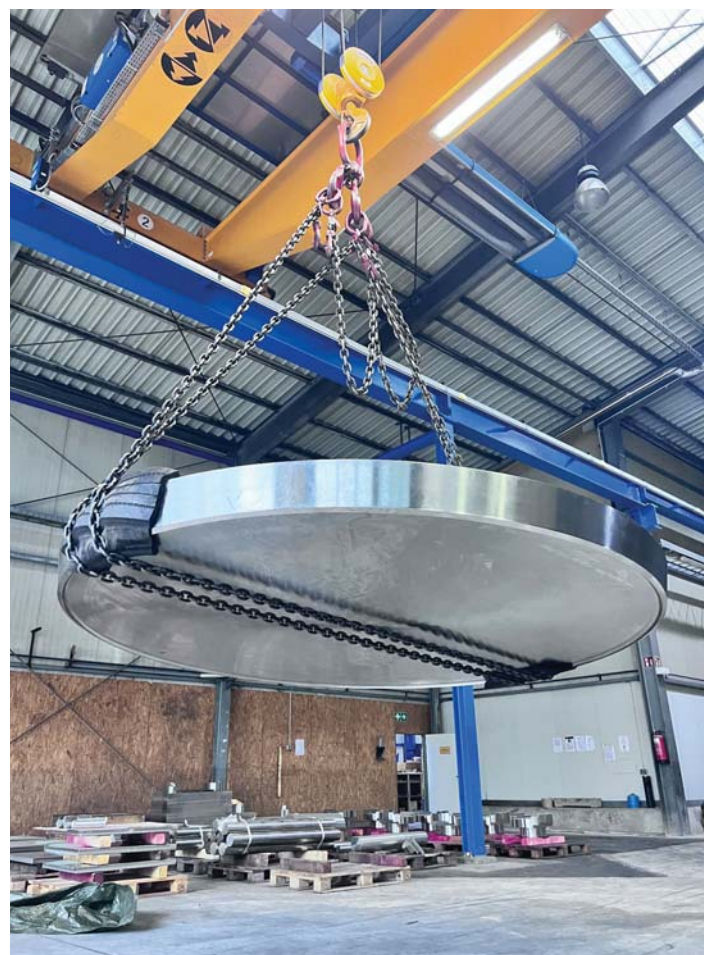
Schmiedestücke aus rost- und säurebeständigen Edelstählen, Nickelbasislegierungen und Titan werden als Einzelteile und in Kleinserien gefertigt.
